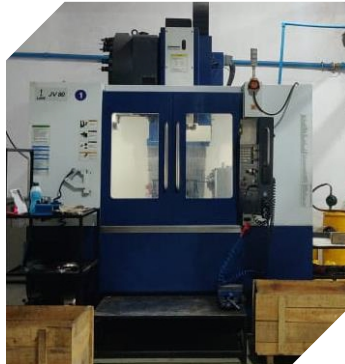
LMW MAKE – JV 80 (Vertical Milling Centre)
