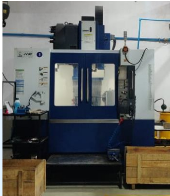
LMW MAKE – JV 80 (Vertical Milling Centre)
